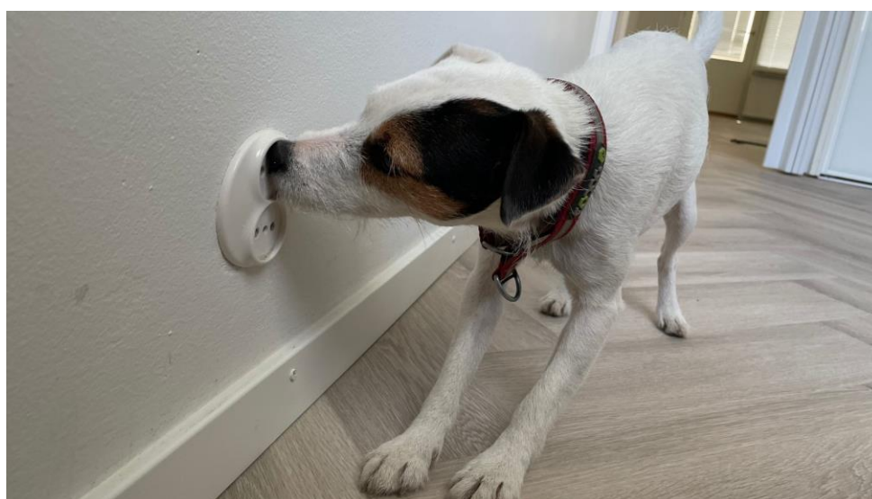
Kuva 11. Koira ilmaisee sähkörasian kautta kulkeutuvan mikrobihajun. Kuva: Leena Stenlund.
