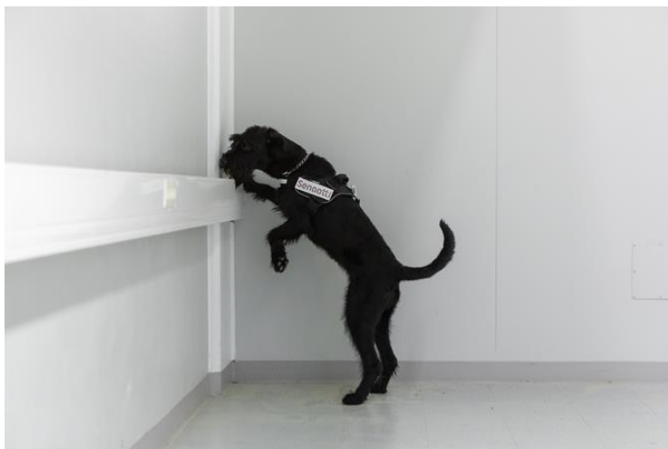
Kuva 1. Homekoira tekee ilmaisun rakennuksen ulkonurkkaan. Kuva: Senaatti-kiinteistöt.
