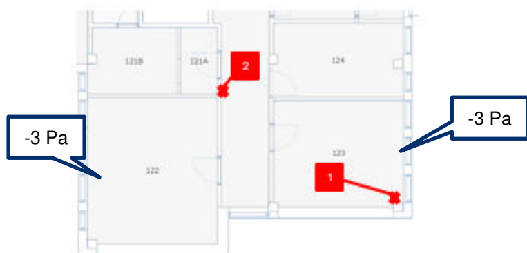
Kuva 1. Tutkitun alueen pohjapiirros, johon koiran ilmaisukohdat on numeroitu ja merkitty punaisella sekä tutkimushetken painesuhteet ulkovaipan yli.
